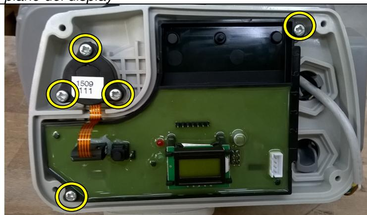
Retire el sensor de presión y la tarjeta aflojando los 5 tornillos indicados
