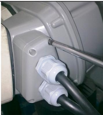
Abrir la tapa lateral prensacables (4 tornillos)
