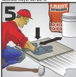
5 Coloque la loseta con los cordones paralelos a los cordones del sustrato procurando moverlas ligeramente hacia arriba y abajo en sentido perpendicular al rayado del adhesivo.
