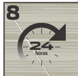
8 Una vez terminada la instalación, será necesario esperar 24 horas para juntear o emboquillar (este tiempo puede variar por las condiciones de clima).
