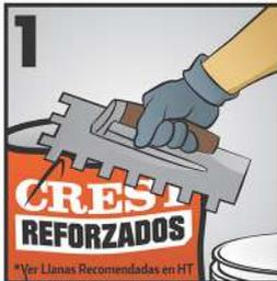
1 Utilice una llana dentada de tamaño apropiado, dependiendo del formato de la loseta a instalar. Que tenga suficiente profundidad para que el adhesivo alcance un área de contacto con la loseta y con el sustrato mayor del 85%.
