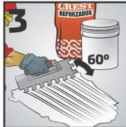
3 Inclinando la llana con la sección dentada en un ángulo de 60° de la superficie, en forma lineal sobre el adhesivo recién aplicado, evitando hacer rayado en forma de abanico.
