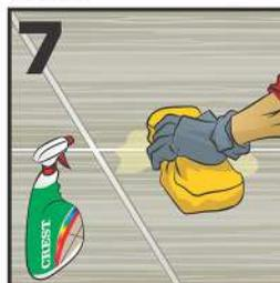
7 Limpie los residuos de adhesivo una vez terminada la instalación con una esponja o trapo húmedo. Remover el exceso de adhesivo en las juntas para tener por lo menos una profundidad en la junta de 2/3 disponible para emboquillar.
