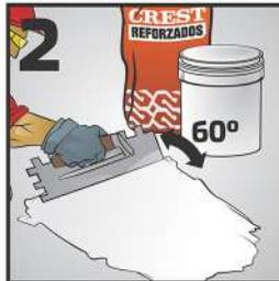
2 Aplique una capa de adhesivo sobre el sustrato utilizando la parte lisa (plana) de la llana sosteniéndola en un ángulo de 60° de la superficie.
