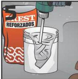
5 Revuelva bien hasta formar una mezcla homogénea. Deje reposar la mezcla 5 minutos. Para lograr una mezcla homogénea se recomienda un mezclador eléctrico de bajas revoluciones.
