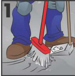
1 Antes de preparar la mezcla, es necesario acondicionar la superficie, la cual deberá estar limpia, resistente, firme, sin grietas, seca y dimensionalmente estable (concreto curado a 28 días).
