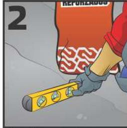
2 Estar perfectamente nivelada y limpia, libre de aceite, grasa, desmoldante, eflorescencia (sales), polvo, pintura, cera o cualquier otro tipo de impureza que inhiba la adherencia.
