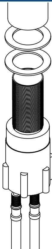
3.- Coloque el monomando sobre el empaque de anclaje y asegure firmemente desde la parte inferior con ayuda de la tuerca de fijación.
