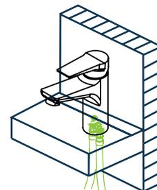
4.- El otro extremo de las mangueras deberán ser conectadas a la línea de alimentación convencional, por medio de válvulas angulares no incluidas.
