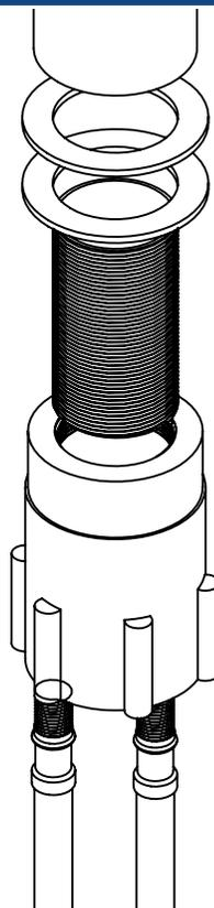
3.- Coloque el monomando sobre el empaque de anclaje y asegure firmemente desde la parte inferior con ayuda de la tuerca de fijación.
