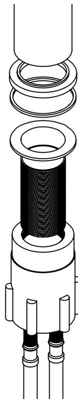
3.- Coloque el chapetón base, posteriormente el monomando sobre el empaque de anclaje y asegure firmemente desde la parte inferior con ayuda de la tuerca de fijación.
