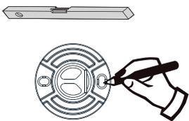
1.- Marque los orificios de la placa de sujeción con un lápiz, una vez que ya sea ubicada la posición del dispensador.
