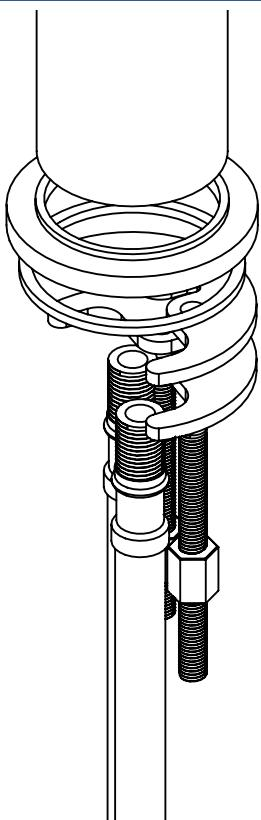
3.- Coloque chapetón base, posteriormente el monomando sobre el empaque de anclaje y asegure firmemente desde la parte inferior con ayuda de la tuerca de fijación.
