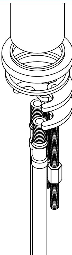
3.- Coloque chapetón base, posteriormente el monomando sobre el empaque de anclaje y asegure firmemente desde la parte inferior con ayuda de la tuerca de fijación.
