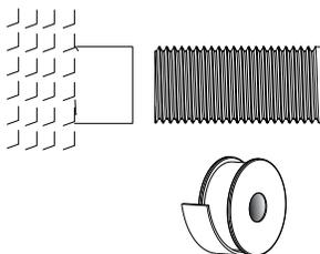
2.-Coloque cinta selladora del otro extremo del conector.
