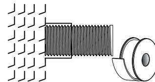
3.-Coloque el chapetón base a la salida y posteriormente enrosque la salida al conector.
