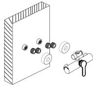
2.- Coloque cinta selladora al adaptador de 1/2" y enrosque a la conexión previamente soldada, coloque los chapetones junto con los empaques de goma y empote al cuerpo de mando
