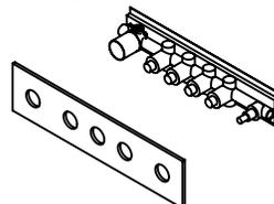
6.- Coloque el soporte de ducha al conector y fije los opresores, posteriormente coloque los manerales y fija los prisioneros.
