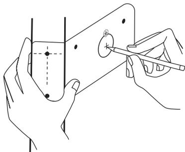
2. Realice las perforaciones en la puerta con los diámetros indicados en la plantilla perforando hasta la mitad aproximadamente y repita la operación en el lado opuesto para evitar dañar la puerta.
